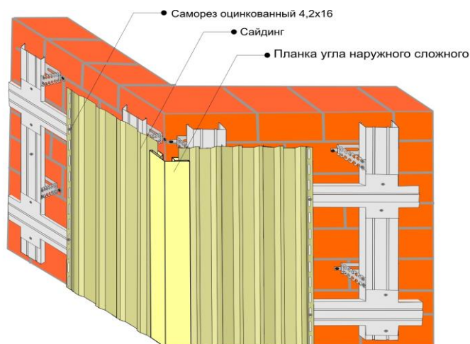
Рис.5 Использование наружного угла при вертикальном монтаже облицовочных панелей
